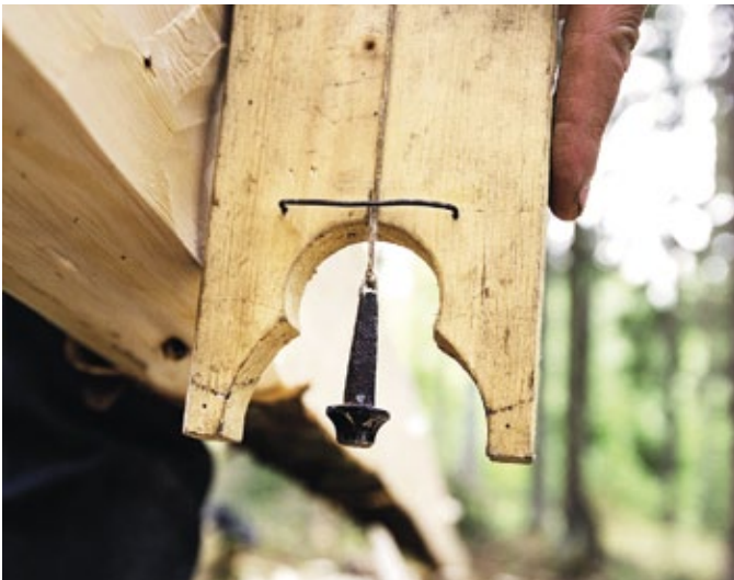
Lodbrädan, en äldre sorts vattenpass, men också en måttbräda. Den är 1 tum tjock, 4 tum bred, 12 tum hög och »fötterna« är 0,5 tum.
